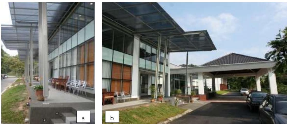
Gambar 29 : (a) & (b) pemandangan luaran Blok Banquet dan Persidangan Puri Pujangga UKM menunjukkan cucur atap yang lebar bagi melindungi dinding luaran dari pancaran terus cahaya matahari. Bahan binaan dan kemasan yang digunakan menggunakan pendekatan 'purity' yang memberikan nilai tampak langsung kepada bahan binaan yang digunakan sebagaimana penggunaan bahan pada rumah warisan Alam Melayu
